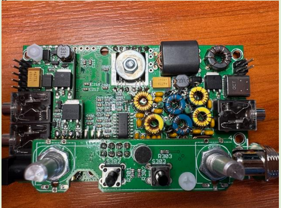
De draaiknoppen en de eerste buck-converter geïnstalleerd
